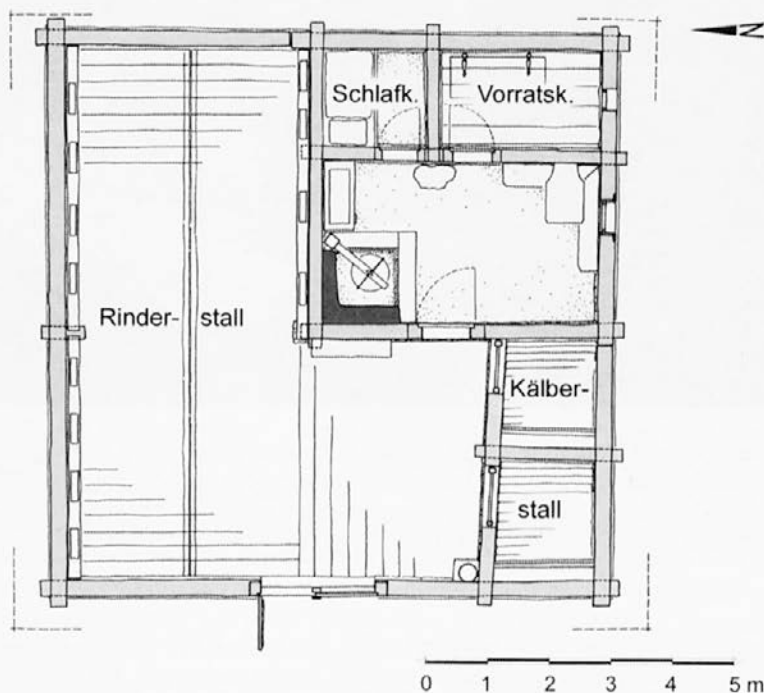
Abb. 14: Grundriß des Brunnerkasers, Mordau-Alm; an den Wohnteil eines ehemaligen Rundumkasers von 1507 wurde 1787 auf zwei Seiten der Stall angefügt
